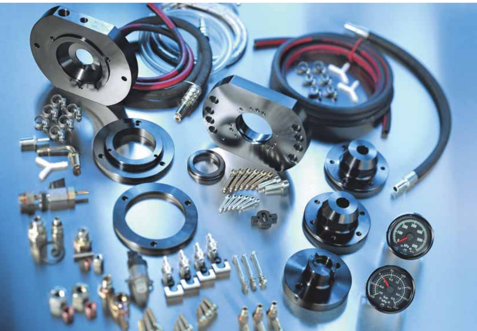
Az ábrán a CP3 nagy nyomású szivattyúhoz használatos célszerszámok láthatók
