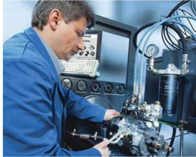
Javítás előtt: Az EPS 815-ös próbapaddal a CP2-es nagy nyomású szivattyú gyorsan és egyszerűen ellenőrizhető.
